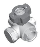
Kugelhahn mit 4 Anschlüssen für Kalt- und Warmwasserleitungen als Absperr-, Füll- und Entleerkugelhahn. Speziell zum Spülen und Füllen von Fußboden-, Decken- und Wandheizsystemen geeignet.
