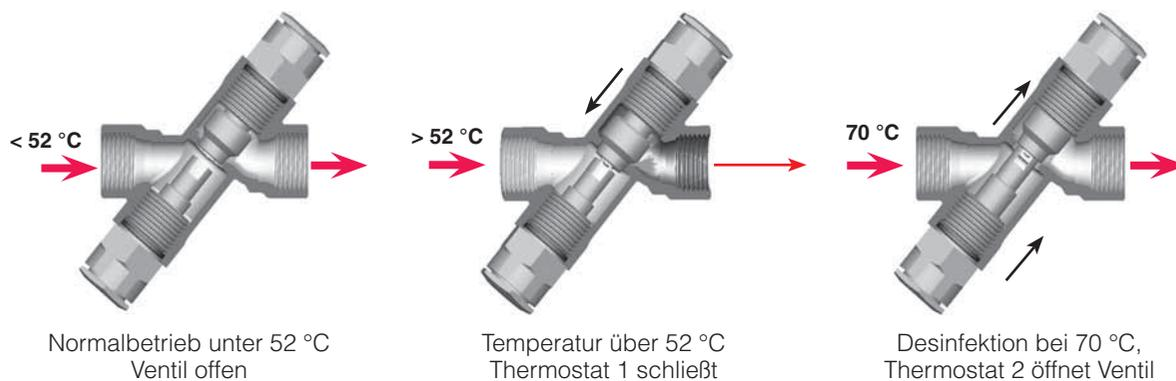
Die beiden Regeleinätze inklusive Thermostatelemente und Kegel ist ohne Ausbau des Gehäuses austauschbar. Funktionsweise bei den Modellen mit 55 °C / 70 °C sinngemäß gleich.
