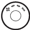
Die Schraubkappe dient zur Betätigung während der Bauphase (Leitungsspülen). Durch Abnehmen der Schraubkappe und Aufschrauben des HERZ-Thermostatkopfes wird das Thermostatventil gebildet, ohne Entleeren der Anlage.
